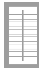
piatti orizzontali sezione 30x5 mm profili verticali sez. quadrata 14 mm
