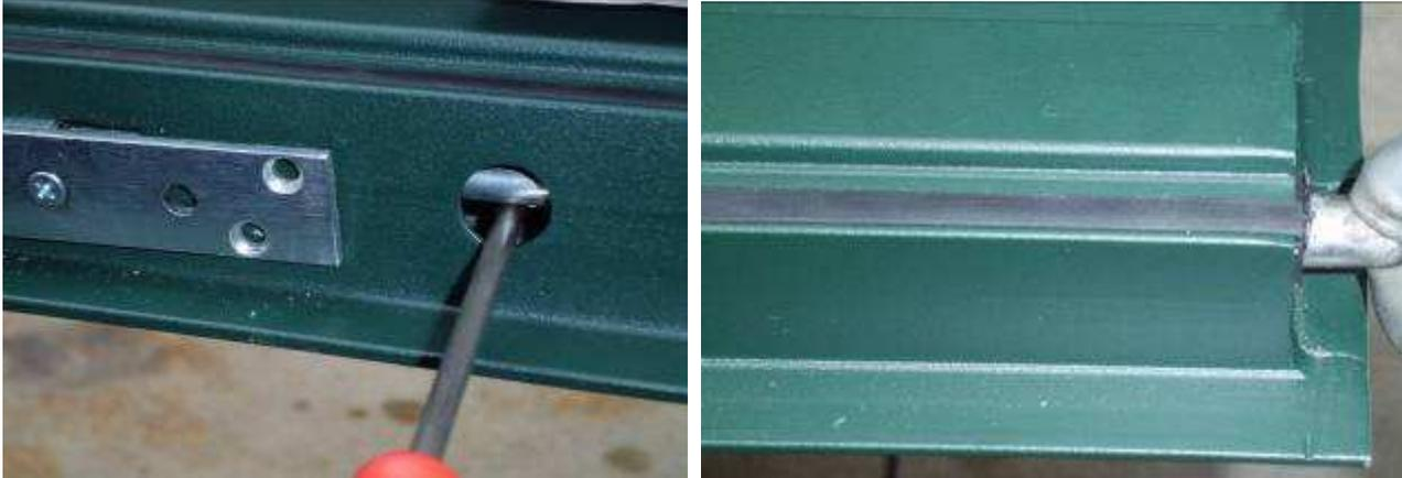
Sostituire la serratura e riavvitare i puntali aiutandosi con i fori di servizio.
