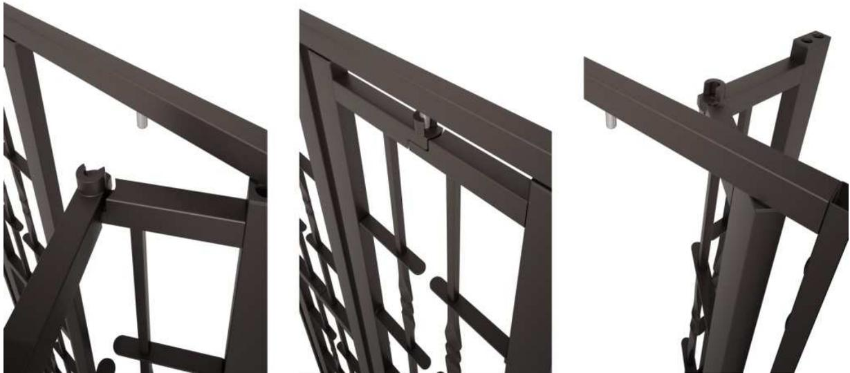
**TEKNO** viene proposta di serie con **snodo da 200 mm.** per consentire lo scavalco di murature e/o di ante persiane. Su richiesta è possibile ricevere snodi da L 200 - 250 - 300 - 350 mm. Lo snodo è ricavato dall'Acciaio Pieno e poi accuratamente saldato ai tubolari trasversi da 40x30 sp. 2 mm.
